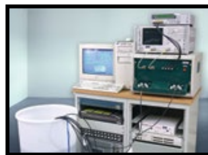
Próba kąpieli wodnej to sześciomiesięczny test, podczas którego kable są całkowicie zanurzone w wodzie.
