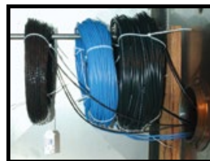
Kable zostały przetestowane w piecu wysokotemperaturowym.
