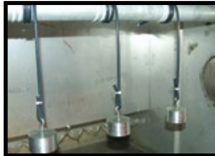
Następnie były nawijane dookoła trzpienia i poddawane naprężeniu przez zawieszenie aluminiowego ciężarka.
