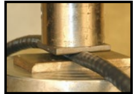
Kabel DataTuff ulega uszkodzeniu dopiero przy przyłożeniu siły rzędu 1 tony.
