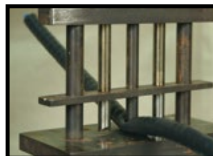
Trzpień z dociskiem klinowym na maszynie Instron wykonuje procedurę przecinania.
