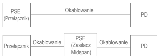
Rysunek 1. Podstawowy schemat i nazewnictwo PoE.
