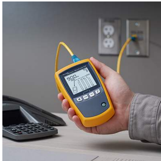
Rysunek 5. MicroScanner PoE może wykryć moc oferowaną przez PSE, a dodatkowo prędkość sieci. Posiada także zestaw funkcji do testowania okablowania.
